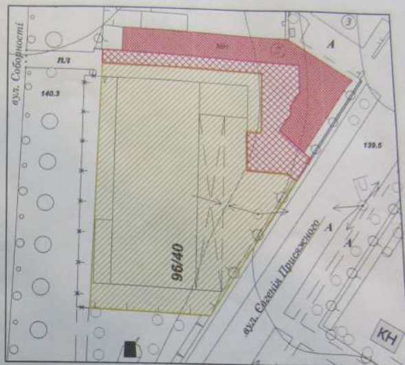
Схема поділу земельних ділянок відповідно до функціонального призначення по вул. Соборності 96/40 (пропозиція ДПТ). М 1:500
